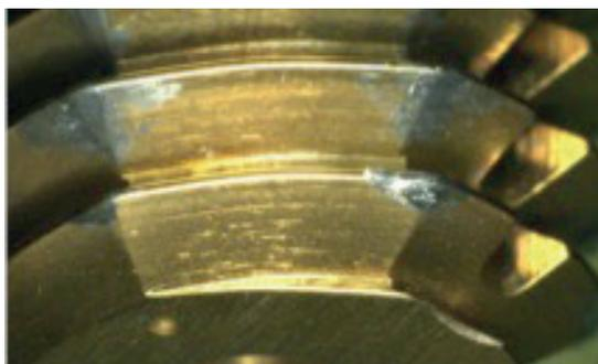
L'accumulo di alluminio sui bordi dell'utensile cambia la forma di quest'ultimo, riducendo la qualità della finitura superficiale
