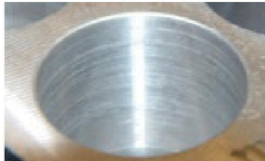
Una scarsa lubrificazione riduce la finitura superficiale, 0,8 Ra, e può portare ad elevati scarti di produzione
