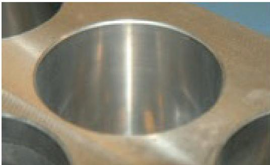
La buona lubrificazione di Castrol Alusol produce una finitura di alta qualità, con rugosità media (Ra) pari a 0,1 per componenti di precisione
