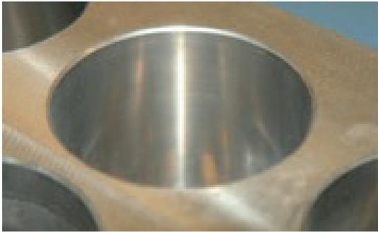
Une bonne lubrification avec Castrol Alusol produit. Un état de surface de qualité supérieure, 0,1 Ra (Roughness average, rugosité moyenne) pour les pièces de précision
